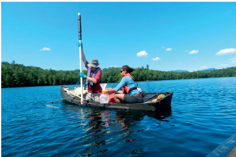
在新英格兰地区的一座大湖上,现场工作人员正在用综合采样装置进行水样过滤与分析
