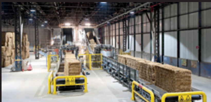
意大利克雷申蒂诺纤维素燃料乙醇工厂, 正在等待处理的秸秆。工厂从秸秆等农业废弃物中提取出纤维素后, 加入生物酶进行水解发酵, 形成燃料乙醇。燃料乙醇的二氧化碳总排放量比石油产品减少了80%以上。 来源: Novozymes
