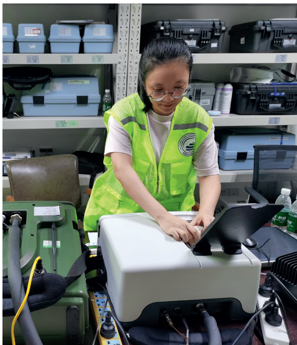
比赛选手使用便携式气相色谱—质谱联用仪（GC—MS）分析挥发性有机物 摄影 / 黄薇
